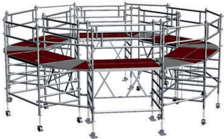
Montaje de andamios en círculos con elementos de esquinas flexibles.
