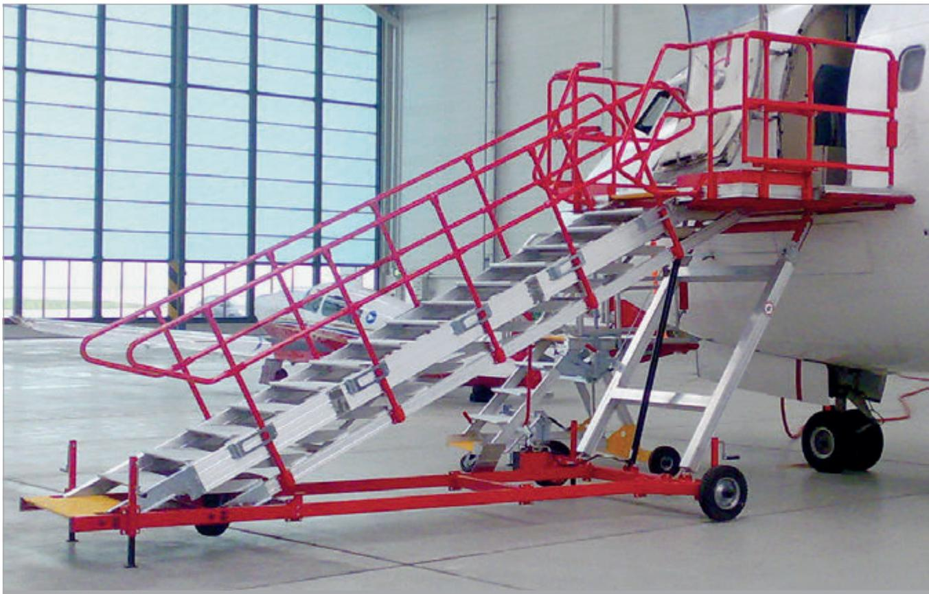
Escalera de mantenimiento con altura regulable. Las barandillas de la plataforma son extensibles para una máxima seguridad
