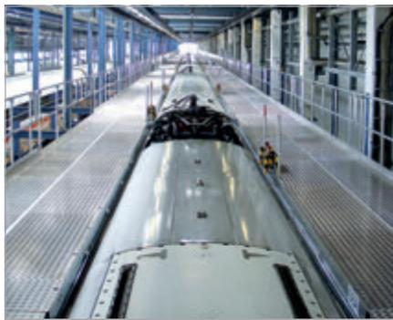
Plataforma acceso a techo de 920 m para tren de alta velocidad
