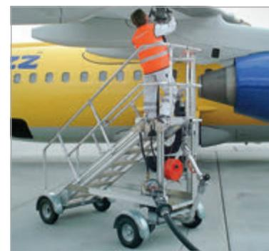
Escalera con altura fija para repostaje de aviones
