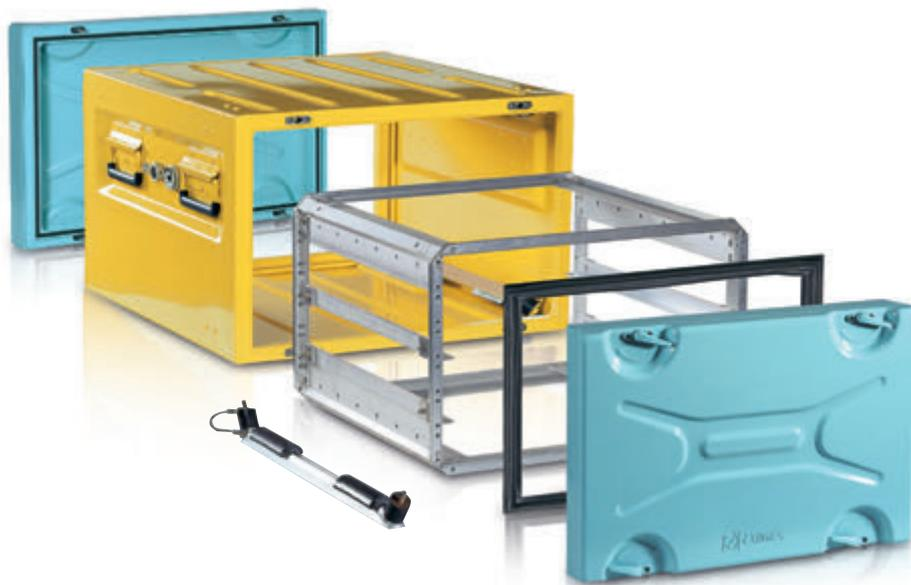
Mitraset® son contenedores rack de 19", diseñados para el transporte de equipos electrónicos. Ofrecen protección contra golpes, impactos, vibraciones, ondas electromagnéticas, rayos, calor, polvo o humedad. Para cumplir con estos objetivos, los contenedores rack de 19" Mitraset® están fabricados con un cuerpo exterior de aluminio de primera calidad con soldadura de cordón, y un bastidor rack en el interior suspendido sobre silentblocks, donde se instala el equipo electrónico.
