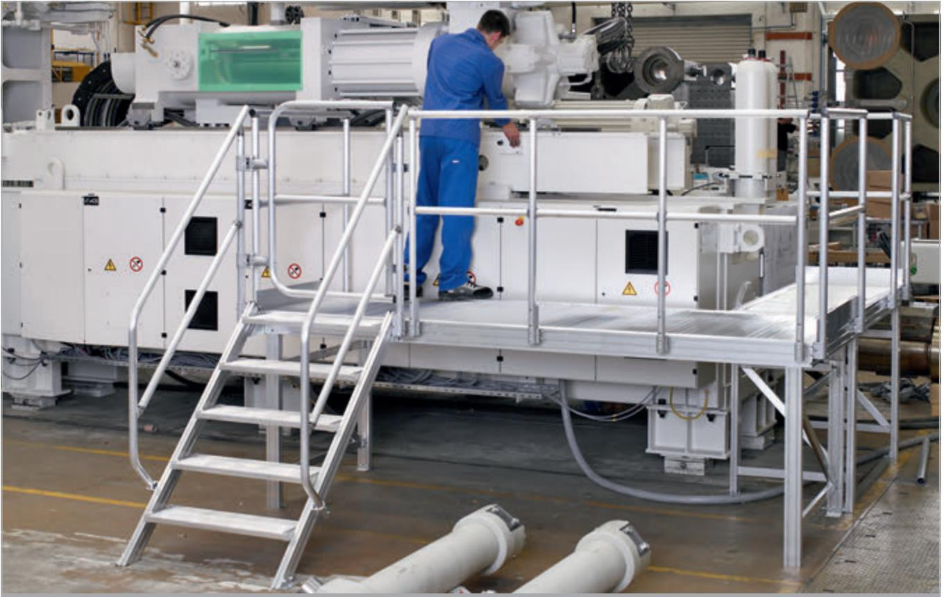
Plataforma para mantenimiento adaptado al contorno de la máquina
