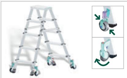
Montaje 4 ruedas fijas: la escalera se desplaza recta. Montaje 4 ruedas giratorias: se despla recta y gira. Ambas opciones con 2 barras anti-cierre.
