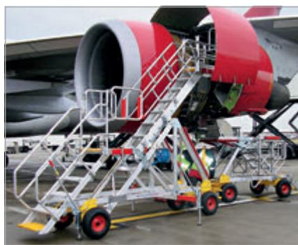
Escalera para mantenimiento en línea de aviones, perfectamente adaptada al modelo del avión
