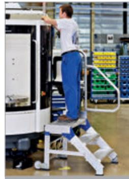
Pedestal para montajes y mantenimientos en máquinas e instalaciones
